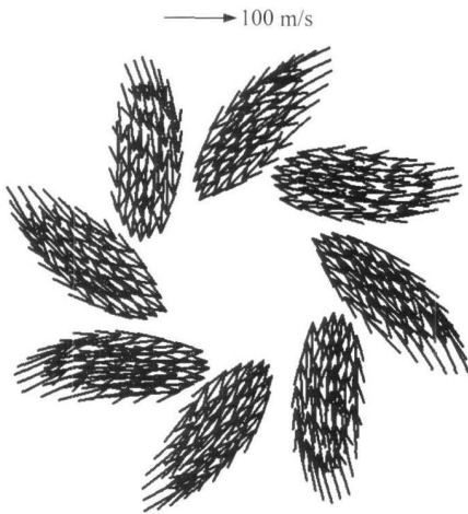
图 10 燃烧室 B 斜切涡流器进口截面( I=56 )速度矢量 Fig. 10 Velocity vector profiles of combustor B ( I=56 )
